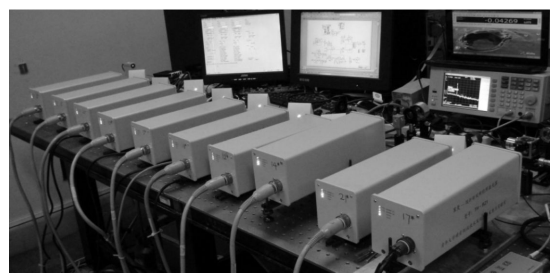
图 6 双折射塞曼双频激光干涉仪激光头现场测试
