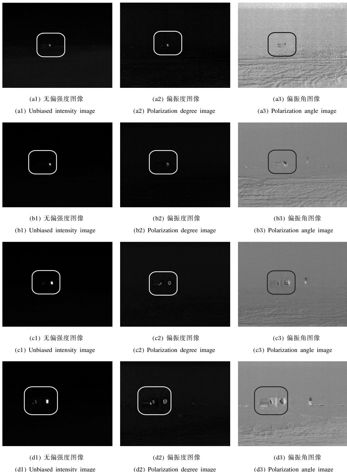
图 5 挂着燃油桶的卡车由远及近长波红外偏振成像
