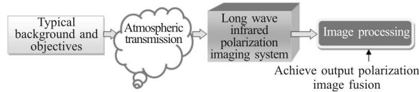
图1 长波红外偏振光学目标探测过程图
