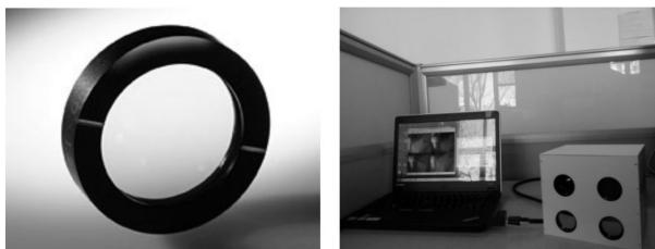
(a) 长波红外偏振成像系统所采用的偏振片
