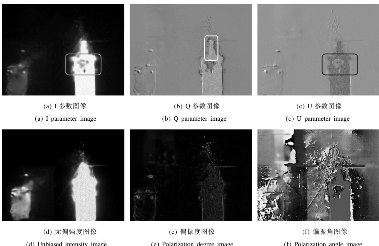
图 6 卡车上挂着的燃烧瓶的长波红外偏振成像
