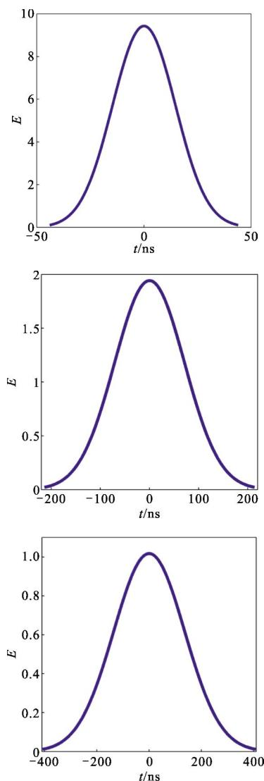
图5 椭圆高斯足印条件下三种目标对应的回波信号形态分布
