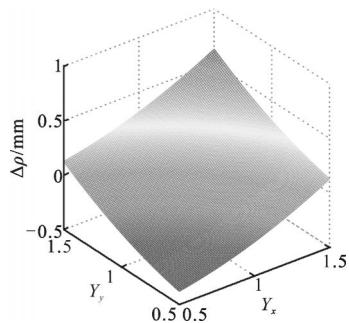
图 3 椭圆高斯足印的椭圆率对激光测距值余量的影响
