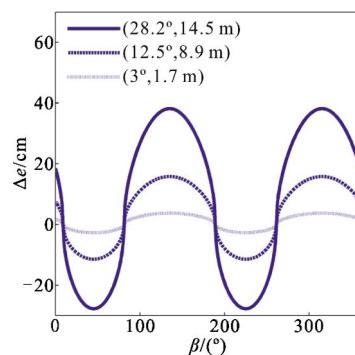
图6 三种目标对应的激光测距误差余量椭圆方位角变化的分布曲线
