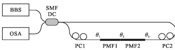
图 1 保偏光纤 Sagnac 干涉仪的原理示意图
