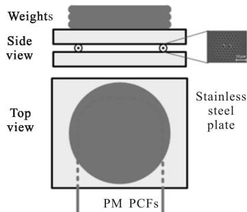
图 9 压力加载装置示意图
