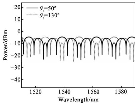
图3 不同 $\theta_a$ 下的仿真干涉谱Fig.3 Simulated interference spectrum with different  $\theta_a$
