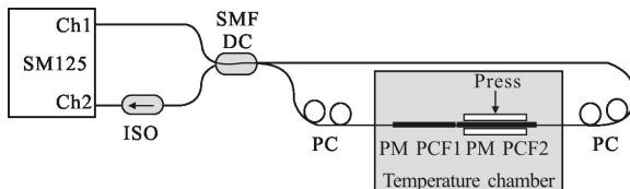
图 13 温度实验装置原理示意图
