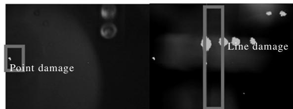
图 2 激光单脉冲点损伤效应、线损伤效应
