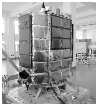
图 7 视频星整星振动试验
