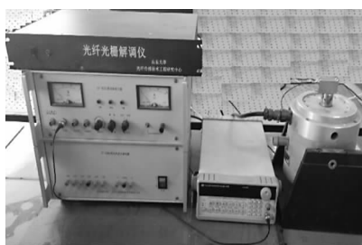
图 7 光纤光栅加速度检测系统性能指标测试平台
