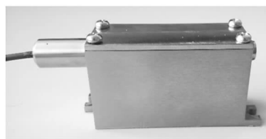
图 5 光纤光栅加速度传感器实物图
