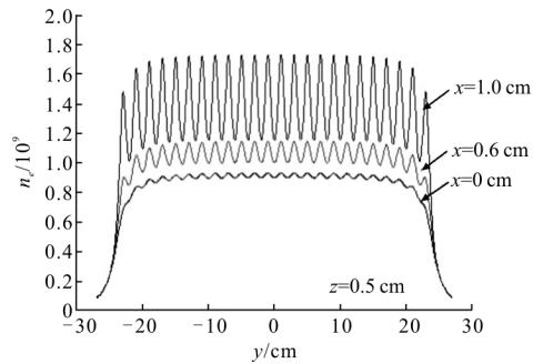
图 3 距光轴不同距离预电离电子密度分布
