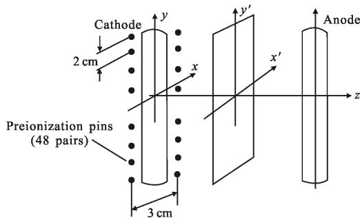
图 2 简化的激光器预电离结构示意图
