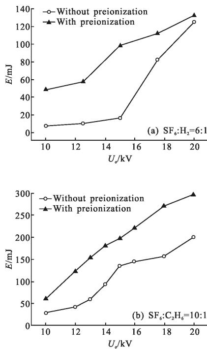
图 6 有无预电离时激光器输出能量比较
