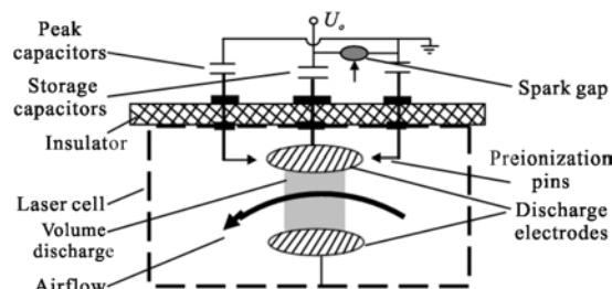
图 1 激光器装置结构示意图
