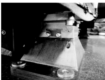
图 12 平动支座实验照片
