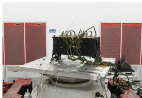
图 7 成像单元力学试验
