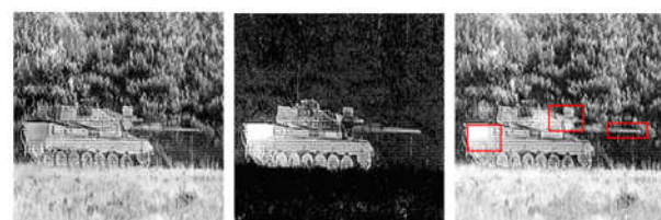
(c1) 红外光图像 (c2) 可见光图像 (c3) 融合后图像 (c1) Infrared image (c2) Visible image (c3) Fused image
