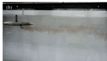
图 12 t=10.0 s 时,热尾流数值模拟温度云图和实验拍摄图像
