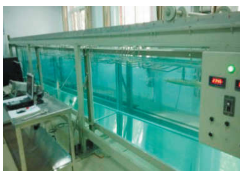
图 1 潜艇尾流排放模拟实验平台实体图
