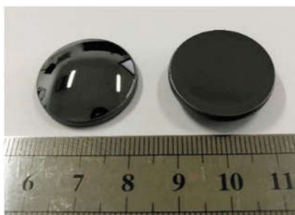
图 3 模压后的 As_2Se_3 硫系玻璃镜片
