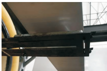
图 4 加热及支撑装置
