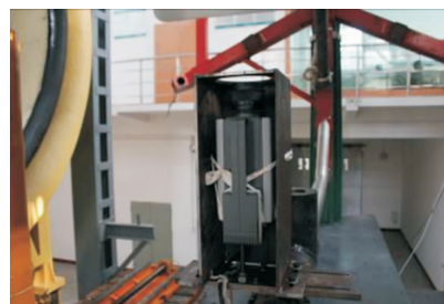
图 3 红外热像仪与支撑装置
