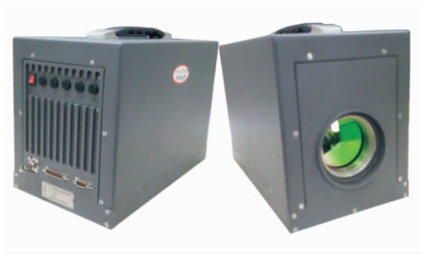
图 5 试验用的中波红外热像仪 Fig.5 MWIR imager used in the field experiment
