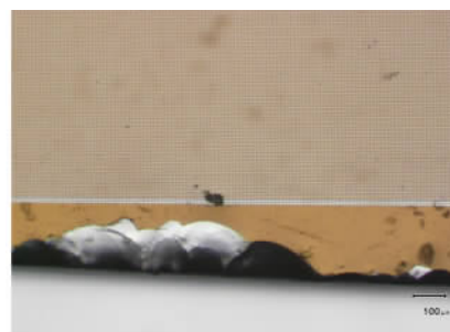
图 6 切磨过程中像素偏振片阵列崩边儿现象图
