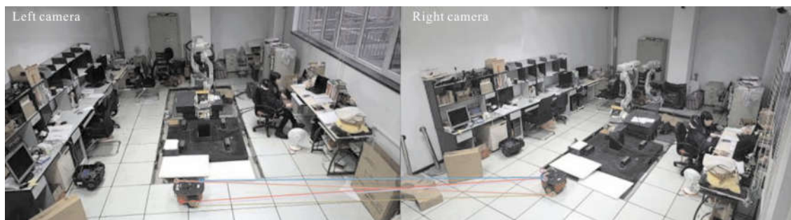
图 5 基于 SURF 算子的移动机器人特征匹配
