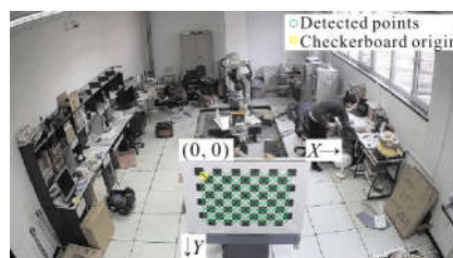
图 10 摄像机内参数的标定
