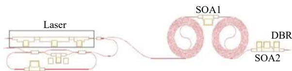
图 8 长外腔结构集成混沌半导体激光器
