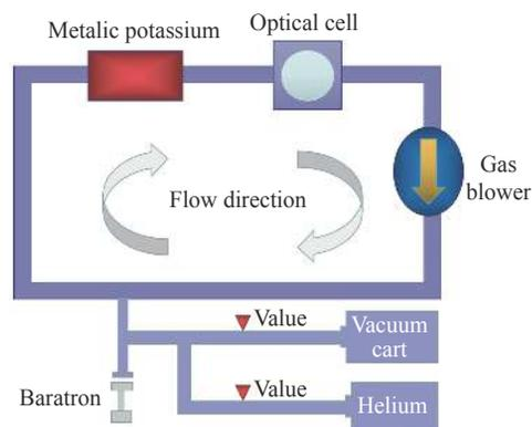
图 2 气体循环流动装置示意图
