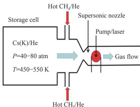
图 3 超音速 DPAL 原理示意图
