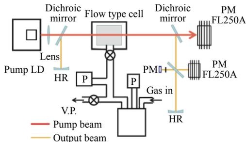
图 12 循环流动 Cs-DPAL 实验装置图
