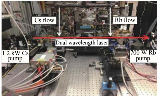
图 11 Rb-Cs 多波长 DPAL 激光装置图
