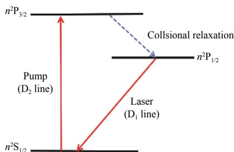
图 1 碱金属原子泵浦能级跃迁图
