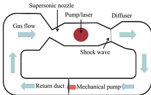
图 4 超音速 DPAL 循环流动装置原理图
