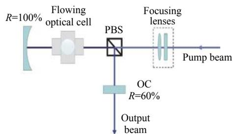
图 8 端面泵浦循环流动 K-DPAL 实验装置图
