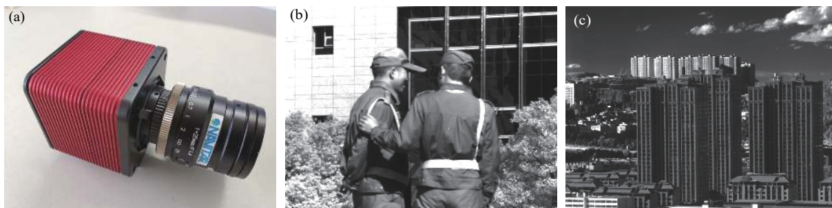
图 9 (a) 640×512 数字化 InGaAs 热像仪样机, (b) 640×512 数字化 InGaAs 热像仪样机近景成像图片, (c) 640×512 数字化 InGaAs 热像仪样机远景成像图片
