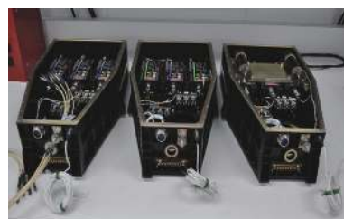
图 12 模式 1(LFOV 和 RFOV) 和模式 3 探测器标准盒 Fig.12 Detector standard boxes for Mode 1 (LFOV and RFOV) and Mode 3
