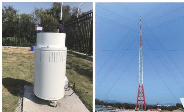
图 6 激光测风系统与气象梯度观测塔
