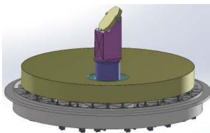
图 12 暗宇宙巡天望远镜 (KDUST) 初始方案的 M1 主镜室模块
