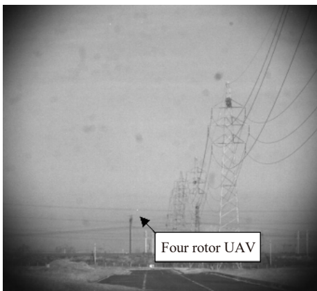
图 5 距离 0.5 km 处微光夜视系统图像 (高增益模式, 时间 20:00)
