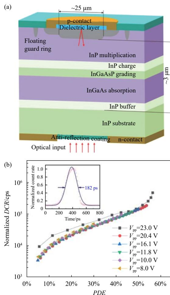
图 2 (a) InGaAs/InP 雪崩光电探测器结构示意图; (b) 器件暗计数和探测效率性能参数, 插图为探测效率为 50% 时的有效门宽<sup>[16]</sup>
