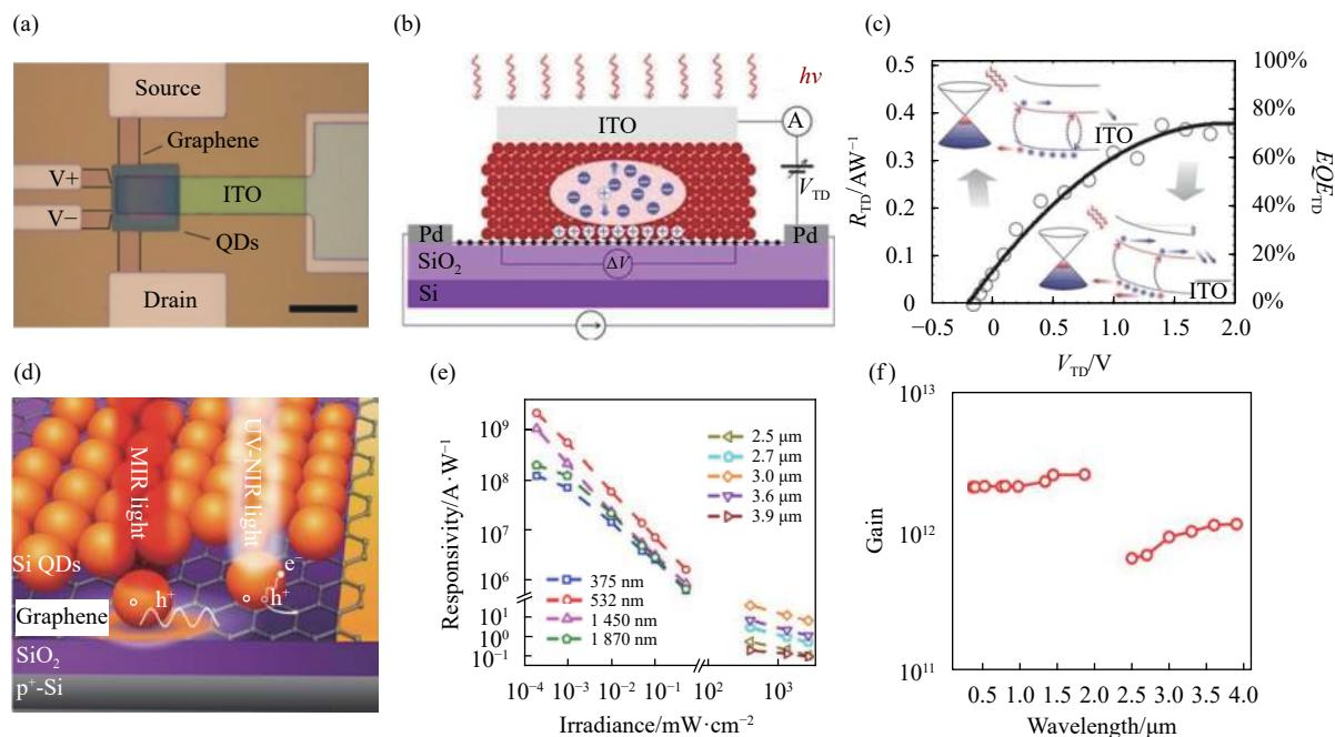
图 7 胶体 PbS 量子点和石墨烯复合结构光电晶体管 (a) 光学显微镜图片和 (b) 结构示意图, 其中 ITO、PbS 和石墨烯在垂直方向形成光电二极管结构; (c) 器件的响应度和外量子效率<sup>[44]</sup>; Si 量子点-石墨烯复合结构 (d) 光电响应机制示意图以及器件的 (e) 响应度和 (f) 宽光谱光电增益<sup>[45]</sup>
