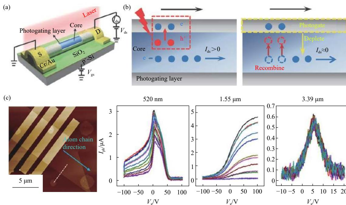
图 6 (a) 室温高增益 InAs 纳米线光电探测器结构示意图和 (b) photogating 物理机制<sup>[35]</sup>; (c) 碲烯中红外高增益光电探测器原子力显微镜图像和不同波长下的光电流<sup>[37]</sup>
