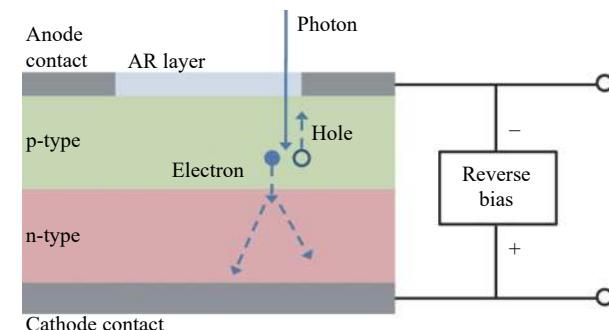
图 1 雪崩光电二极管结构及工作原理<sup>[5]</sup>
