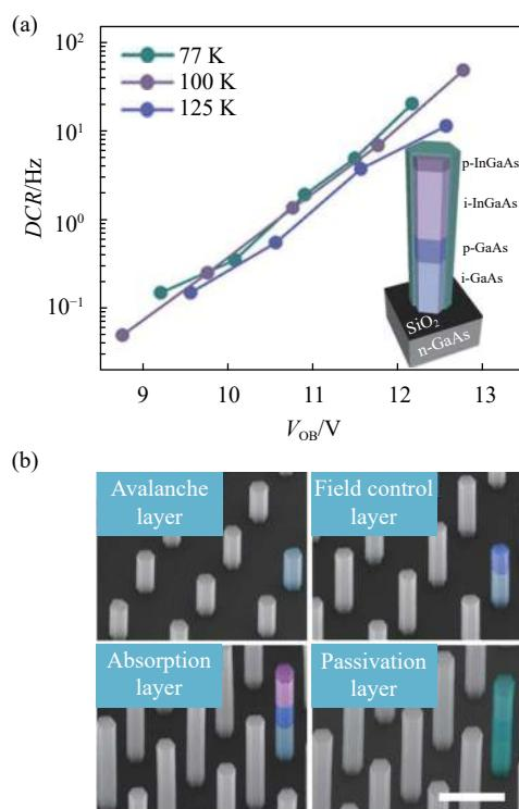
图3 (a) InGaAs-GaAs雪崩探测器在不同温度下的暗计数,插图为器件结构示意图,器件由InGaAs吸收层、GaAs倍增层和InGaP钝化壳层组成;(b) 纳米线生长过程中的扫描电镜图像,比例尺为500 nm<sup>[21]</sup>
