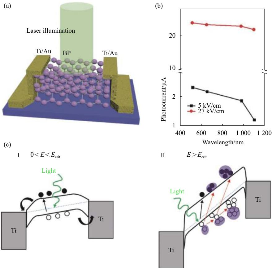
图 4 (a) 基于 BP 的雪崩光电探测器结构;(b) 不同电场强度下器件产生的光电流与波长的关系;(c) 不同电场强度下器件工作机制, 电场强度大于临界电场时, 由于雪崩效应发生载流子倍增<sup>[26]</sup>
