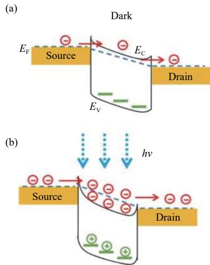
图 5 基于 photogating 效应的晶体管光电响应增益机制<sup>[33]</sup>
