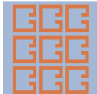
图 22 开口环结构示意图
