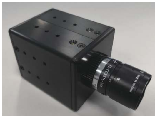
图 7 1280×1024 EMCCD 原理样机
