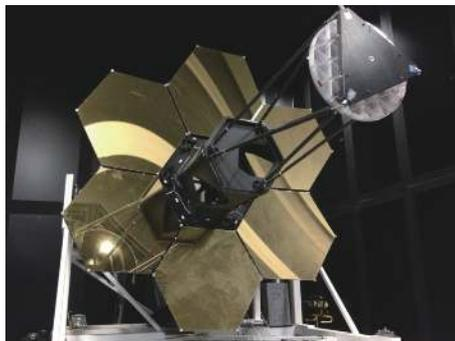
图 3 分块反射镜望远镜
