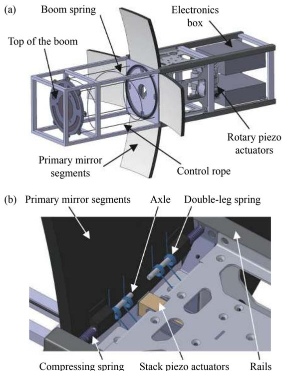
图 9 (a) 零重力环境下展开示意图; (b) 主镜子镜压缩弹簧驱动机构
