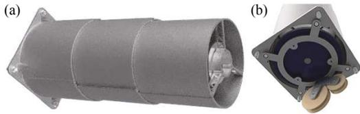
图 15 (a) 展开状态下的镜筒; (b) 安装在主镜后面的弹簧马达
