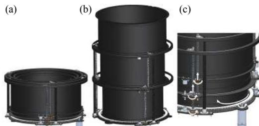
图 14 (a) 折叠状态;(b) 展开状态;(c) 部件的运动方向
