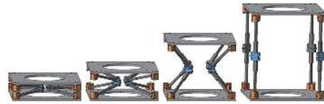
图 16 展开机构工作原理
