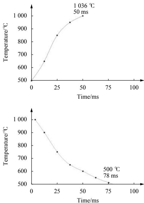
图 9 3 μm 不锈钢片试验结果
