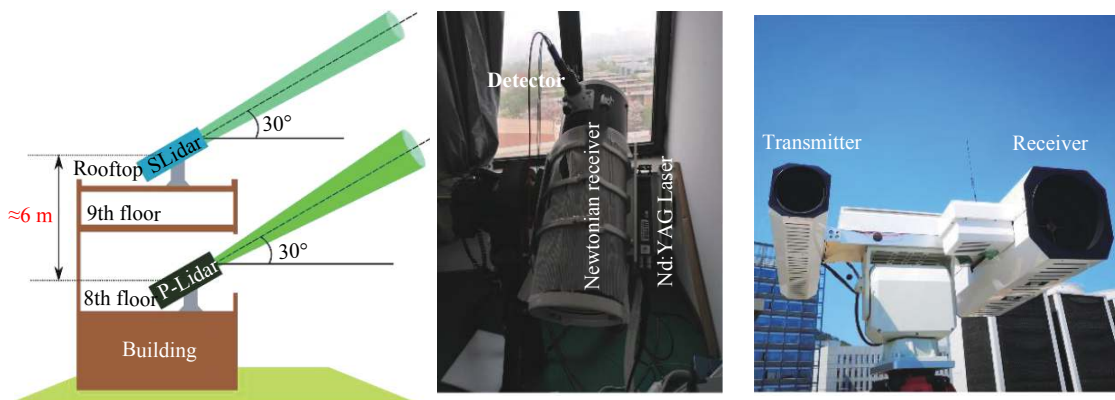
图 4 (a) 对比测量示意图, (b) 脉冲激光雷达系统的实物图, (c) SLidar 系统实物图。防雨 SLidar 系统放置在楼顶, 脉冲激光雷达系统位于实验室内部
