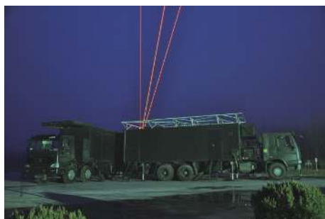
图 3 车载式钠荧光散射多普勒激光雷达
