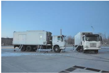
图 6 车载式 532 nm 瑞利散射多普勒激光雷达
