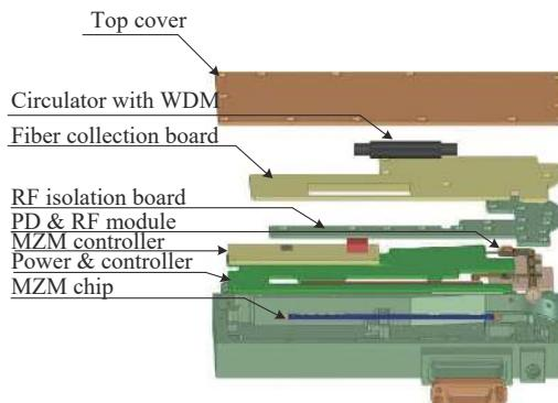
图 4 组件封装结构示意图
