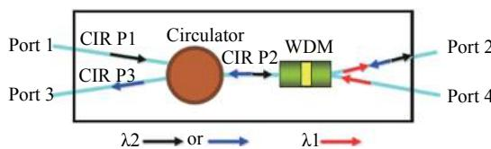
图 7 波分环形器结构示意图
