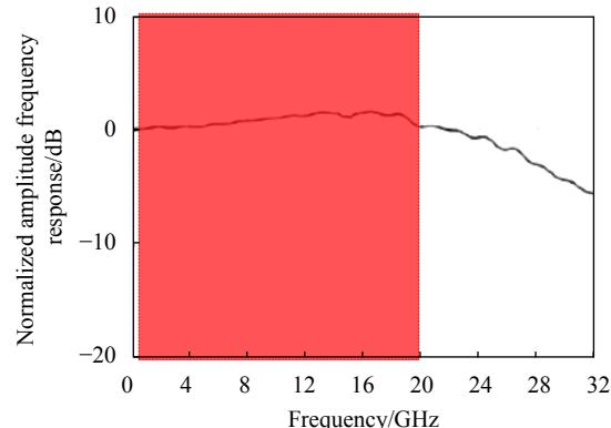
图 5 探测器芯片归一化幅频响应
