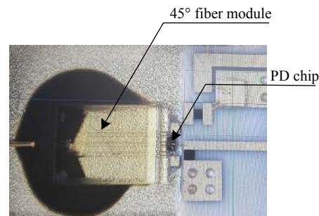
图 6 45° 光纤模组实物示意图
