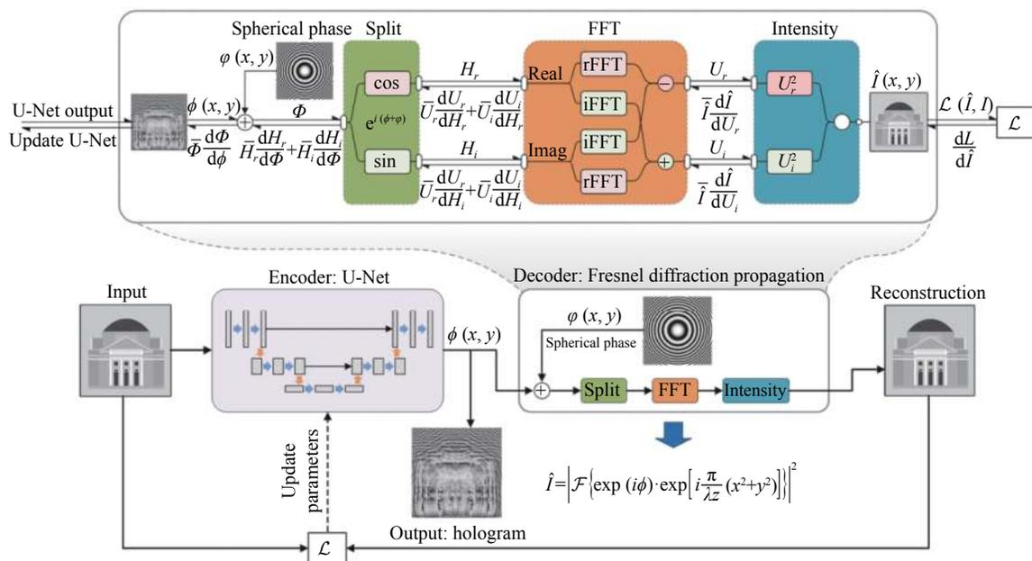
图 8 基于自编码深度神经网络的计算全息图生成算法<sup>[90]</sup>
