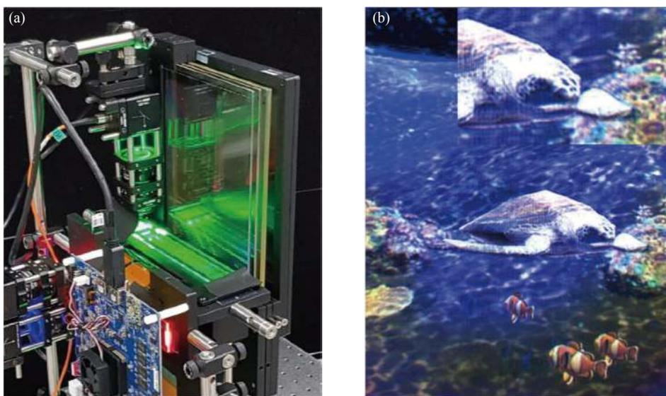
图 6 (a) 超薄全息三维显示系统; (b) 彩色三维全息重建结果<sup>[69]</sup>
