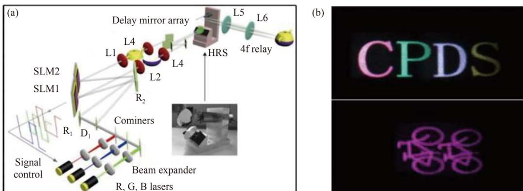
图 5 (a) 基于粗积分的全息视频显示系统; (b) 彩色三维全息重建结果<sup>[68]</sup>
