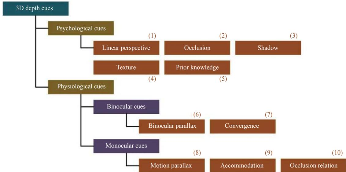
图 1 三维显示中的各类三维深度线索
