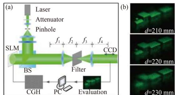
图 4 (a) 全息三维显示系统示意图; (b) 全息三维重建结果<sup>[59]</sup>
