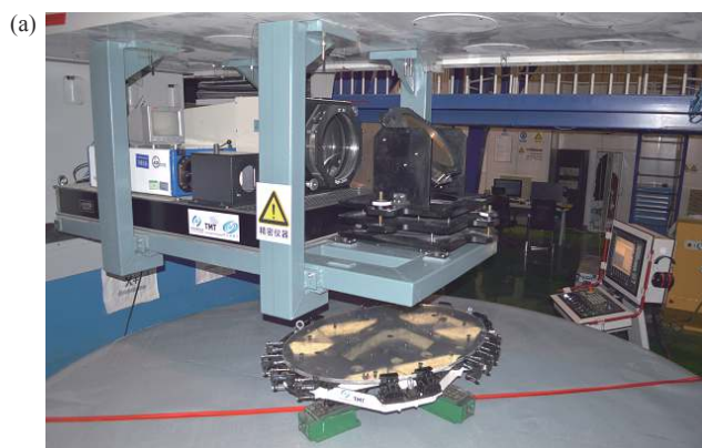
图 12 原理镜子孔径拼接检测装置及规划图
