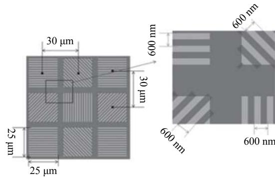
图 5 MPA 及其结构参数示意图
