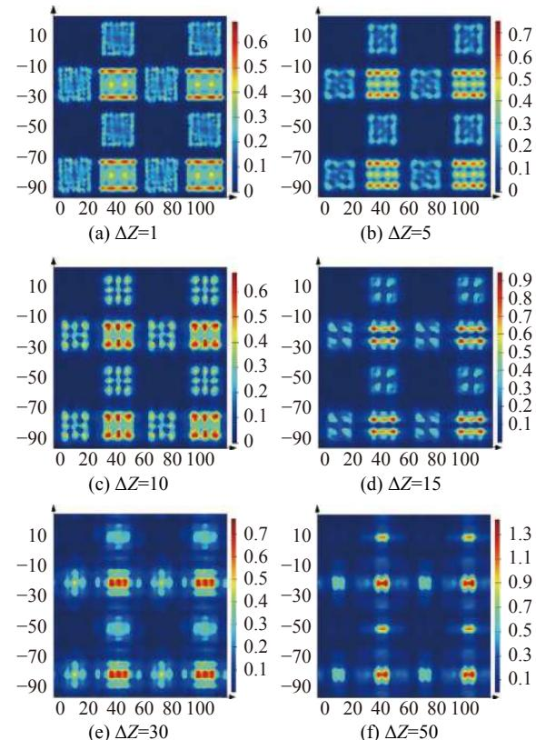
图 6 平面波入射, 距离 MPA 不同距离的强度图 (单位: μm)
