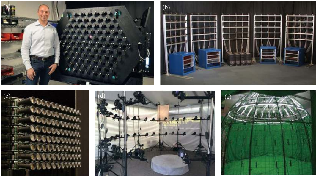
图 154 多相机拼接系统。(a) Lytro 公司所研制的光场采集系统 Immerge; (b) 斯坦福半环型相机阵列系统; (c) 斯坦福平面型相机阵列系统; (d) Camatrix 环型相机阵列系统; (e) 清华大学鸟笼相机阵列系统
