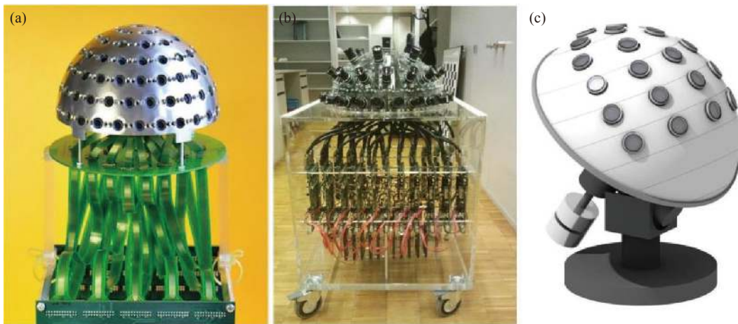
图 155 (a) 瑞士洛桑联邦理工学院 (EPFL) 的科研团队设计并研制了仿生复眼成像设备 Panoptic; (b) 大视场高分辨率的 OMNI-R 系统; (c) Nicholas Law 研制的艾弗里地基望远镜系统 Evrscope
