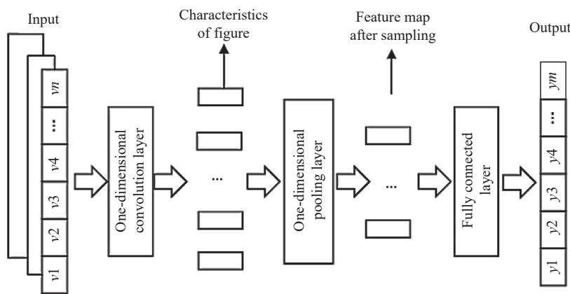
图 5 一维卷积神经网络结构图
