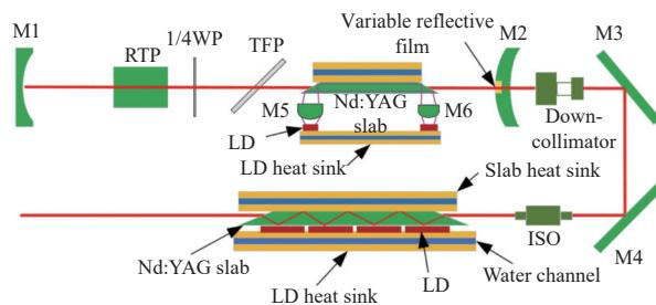
图 3 50 Hz 基频光脉冲放大实验装置
