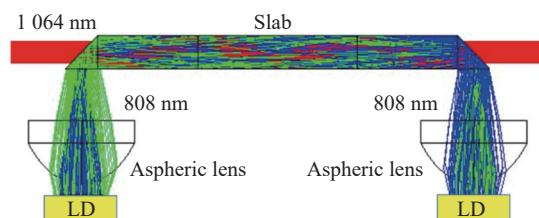
图 4 振荡级泵浦结构示意图
