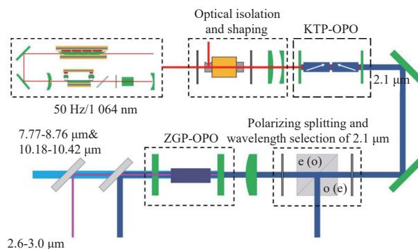
图 2 长波红外激光波长调谐实验装置图
