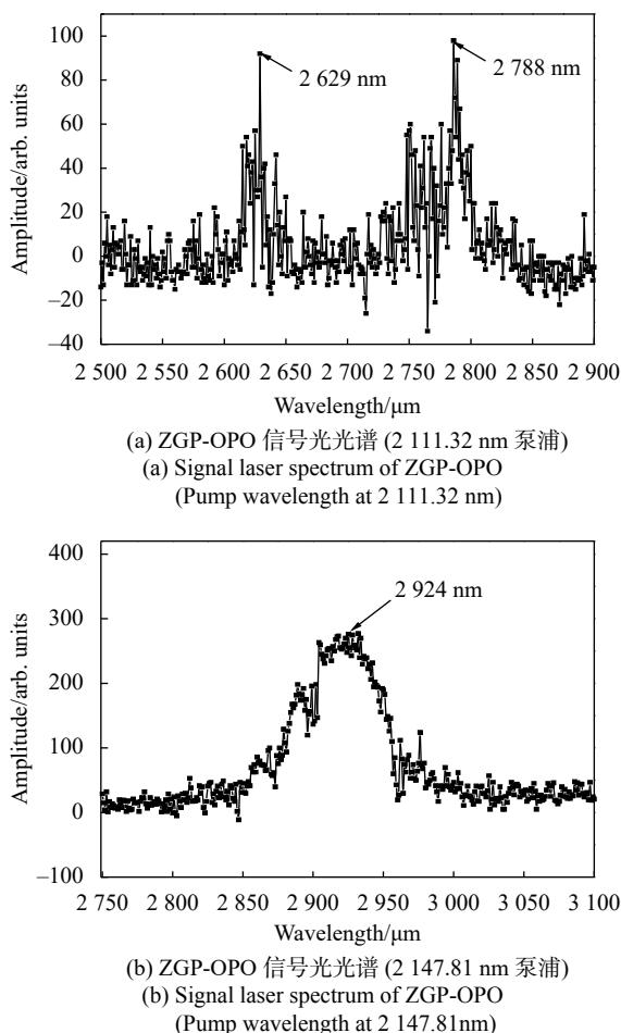
图 12 不同泵浦波长时 ZGP-OPO 信号光光谱
