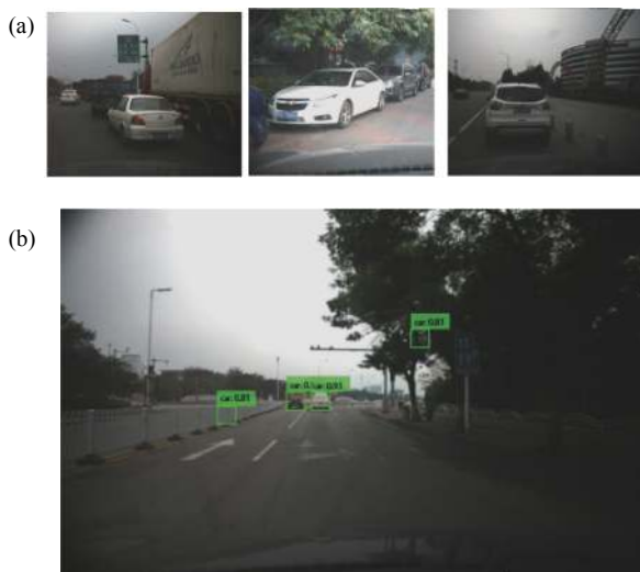
图 4 (a) 采集的车辆图片; (b) 复杂环境下改进的 SSD 算法车辆检测结果
