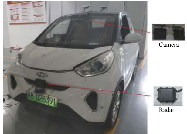
图 6 摄像头和雷达实车安装位置
