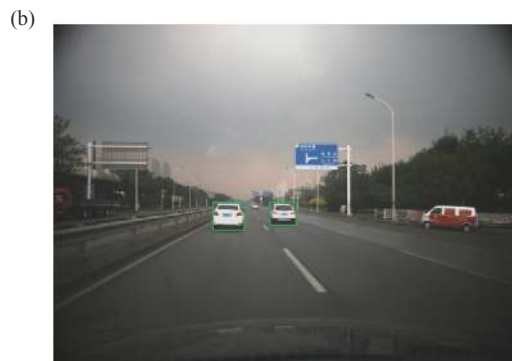
图 8 (a) 摄像头和雷达数据交互; (b) 车辆检测结果
