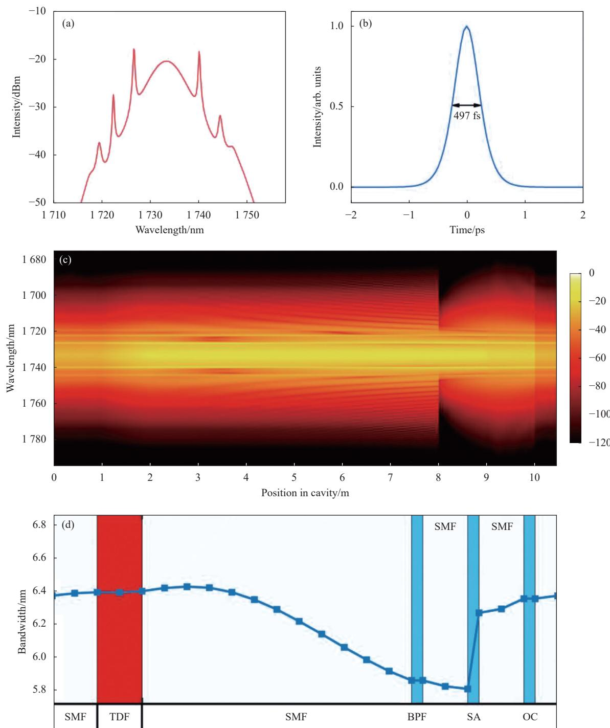
图 4 数值模拟。(a) 锁模光谱;(b) 锁模脉冲;(c) 锁模光谱在激光腔内的演化;(d) 3 dB 光谱带宽在腔内的演化
