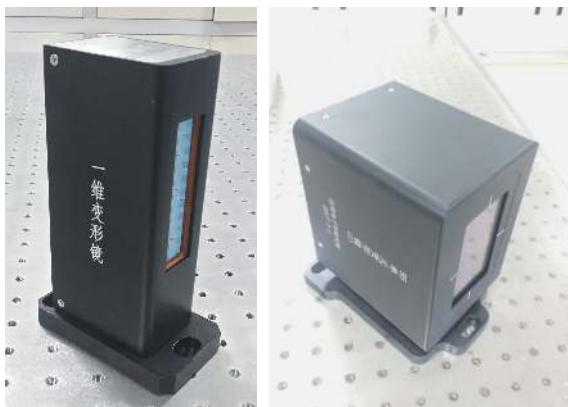
图 24 一二维变形镜实物
