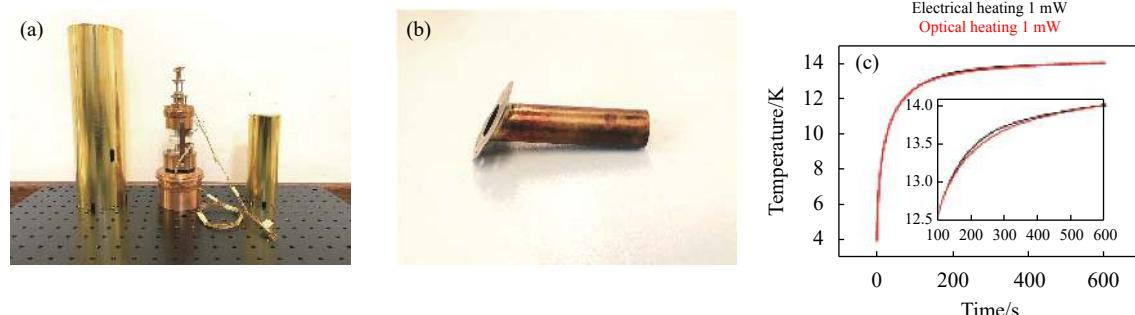
图 9 (a) 低温辐射计热连结构;(b) 低温辐射计高吸收率斜底腔;(c) 不同加热方式下吸收腔温度随时间的变化
