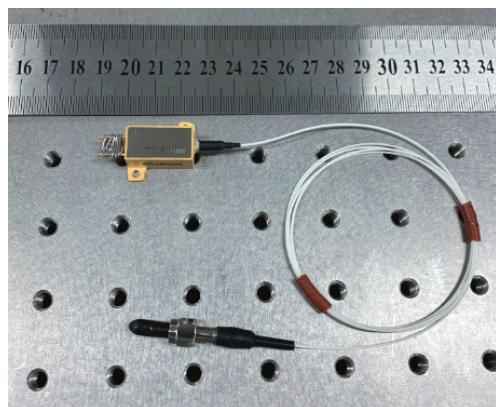
图 1 锑化物半导体激光器光纤耦合模块实物图
