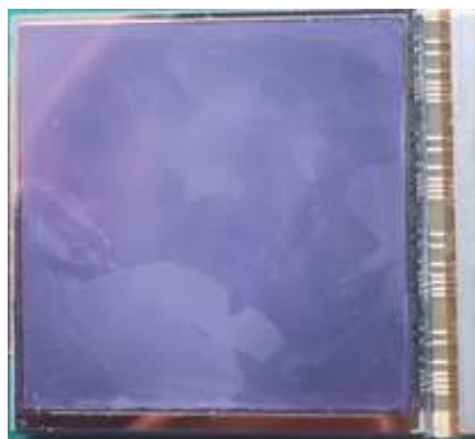
图 8 SW 2 k×2 k(18 μm) 碲镉汞红外焦平面探测器件
