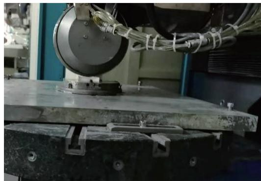
图2 磁流变修复损伤实物图
