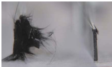
图 13 试件断口横截面形貌
