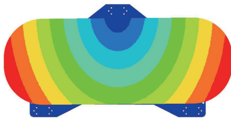
图 11 主镜组件一阶振型
