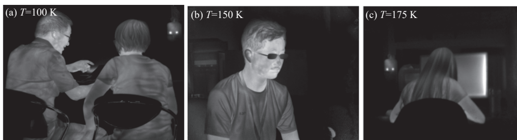
图 1 昆明物理研究所 2019 年研制的中波 \text{InAs}_{0.91}\text{Sb}_{0.09} 焦平面探测器热成像图
