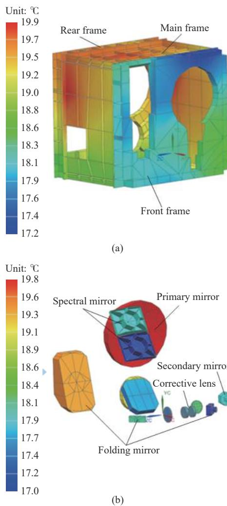
图 5 低温工况光机结构温度分析结果
