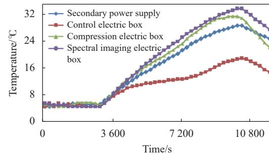
图9 长期在轨工作时各电箱温度
