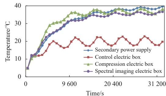
图 6 高温工况各电箱温度分析结果
