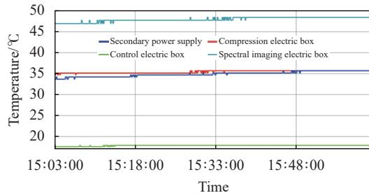
图8 高温工况各电箱温度试验结果
