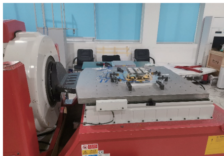
图 6 超大规模冷平台组件振动测试过程照片
